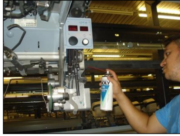
Resim 1.21: Bobin çıkartma kolunun sprej ile temizliği
