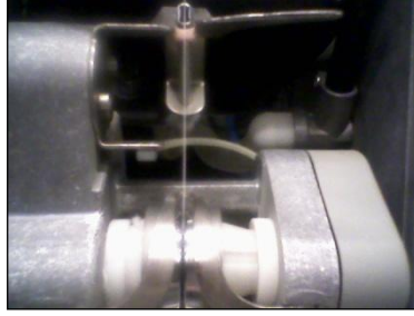
Resim 1.5: Tansiyon kancası ve üst emiş kolu
