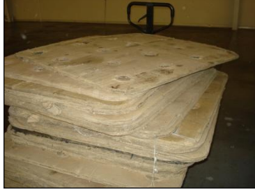
Resim 2.13: Bobinlerin arasına yerleştirilen kartonlar
