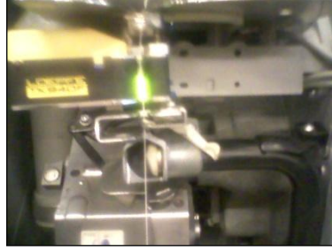
Resim 1.8: İplik temizleme tertibatı ve üst emiş kolu
