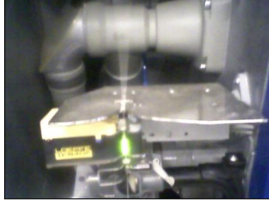
Resim 1.12: Elektronik iplik temizleyicisi
