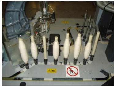
Resim 1.16: Kops ve taşıyıcı kayış
