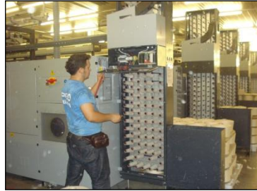
Resim 1.30: Boş apron ünitesi
