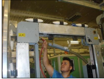
Resim 1.26: Kops rayının hava ile temizliği
