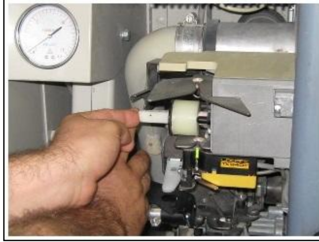
Resim 2.2: Bobin makinesinde ipliğin parafinlenmesi
