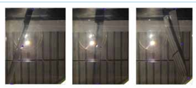
ภาพทิศทางการแกว่งของฉนวนชนิด PET ขนาดความหนา 5 มิล ของการทดลองที่ 1 และจุดไฟกล๊าสที่ใช้เก็บค่าความถี่ของช่วงกว้าง
