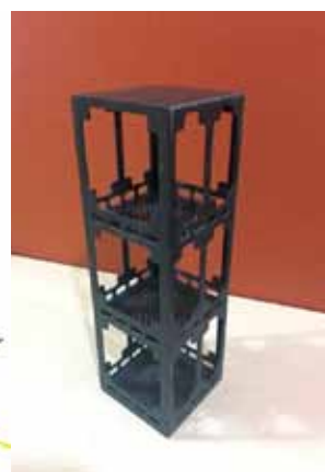
ส่วนประกอบภายในก่อนขึ้นรูปเป็นโมเดล 3U CubeSat
