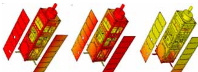
โครงสร้างดาวเทียม 3U CubeSat และการแสดงผลการจำลองการทดสอบ Thermal Transfer
