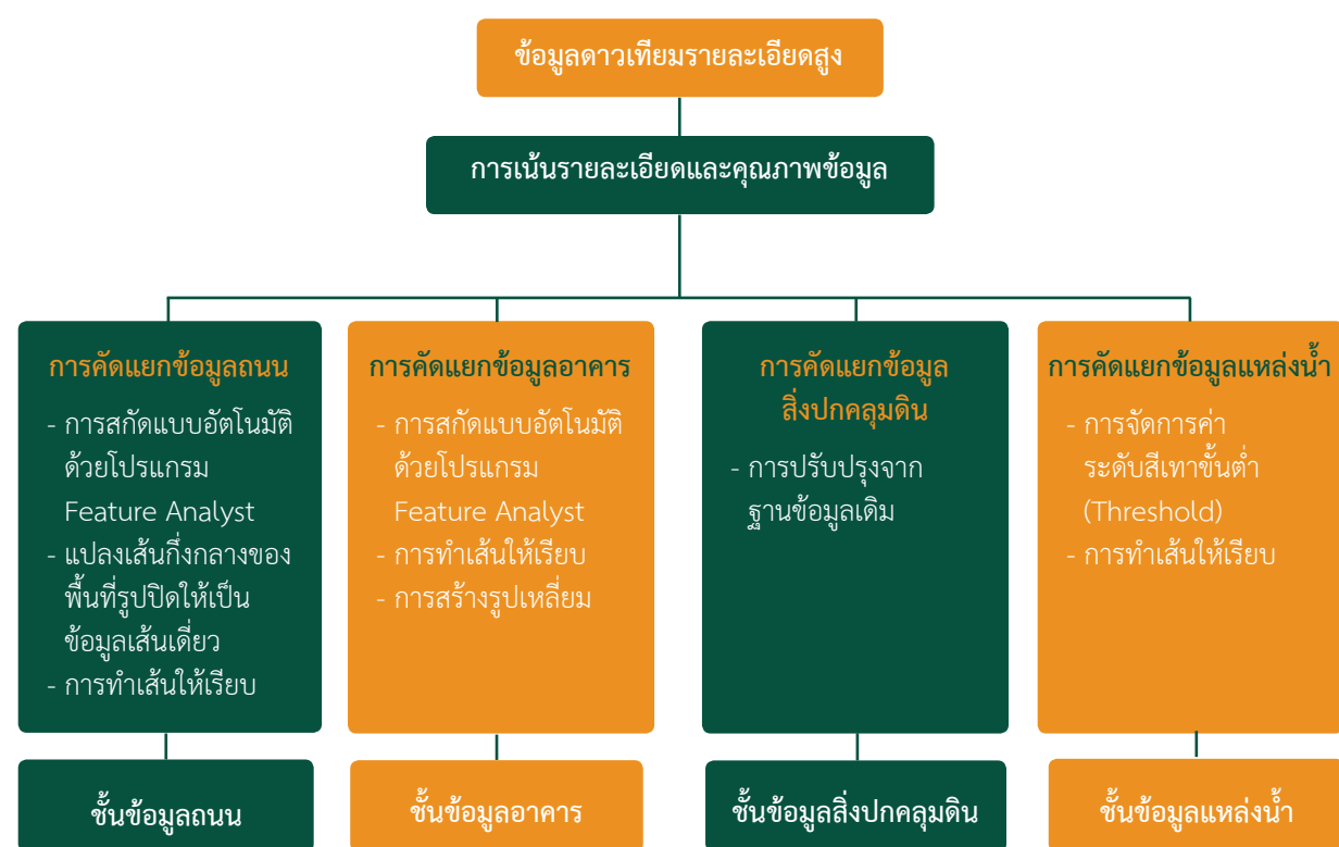
แผนผังแสดงขั้นตอนการจำแนกข้อมูลเชิงเส้นจากดาวเทียมรายละเอียดสูงของทุกชั้นข้อมูล
