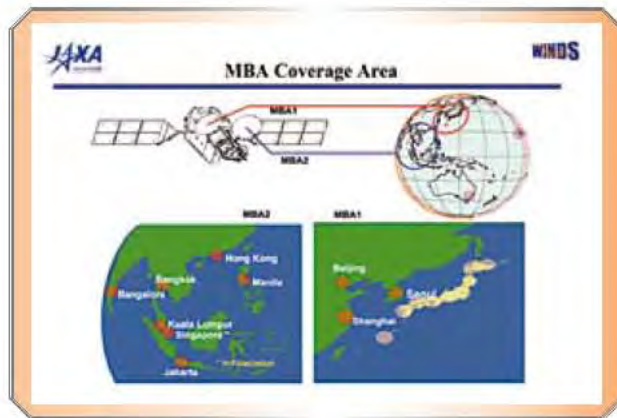
ระบบสื่อสาร MBA บนดาวเทียม WINDS เชื่อมโยงภูมิภาคเอเชียตะวันออกเฉียงใต้กับญี่ปุ่น
