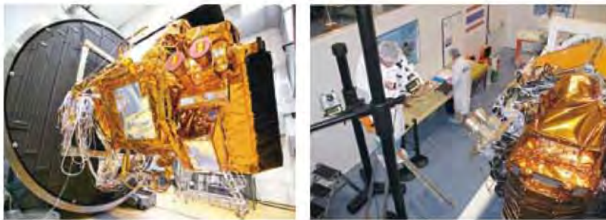
การทดสอบต่างๆ ของดาวเทียม THEOS ได้แก่ Thermal Balance/Thermal Vacuum Test, Solar Array Deployment Test, Alignment Test และ EMC Test
