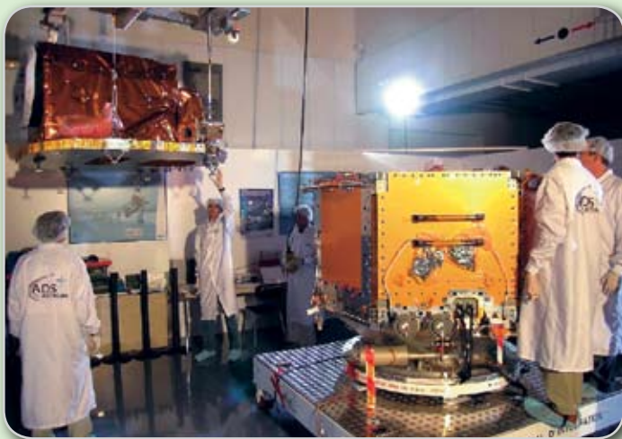
การเชื่อมต่อ Bus และ Payload
