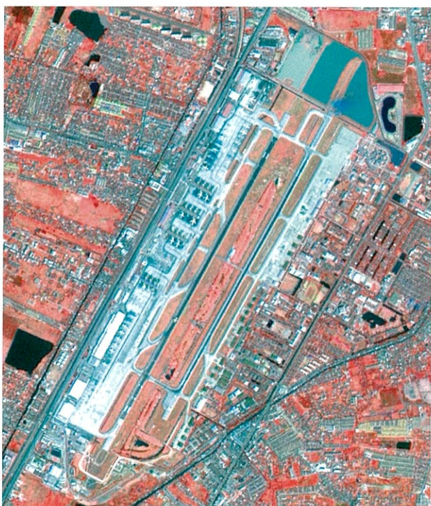
ภาพที่ 5: ภาพจากดาวเทียมบริเวณสนามบินดอนเมืองจากการใช้ระบบสี (Pan-Sharpned) ระหว่างข้อมูลภาพถ่ายดาวเทียม TERRA ระบบ ASTER แบบ VNIR และจากดาวเทียม IRS-1D ระบบ PAN ได้ภาพที่มีรายละเอียดสูงขึ้นเป็น 5 เมตร ทำให้สามารถมองเห็นลักษณะโครงสร้างการก่อสร้างได้ชัดเจนขึ้น
