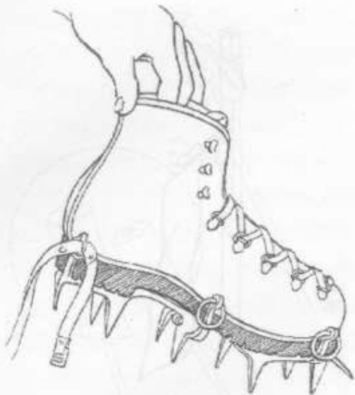
圖13-7 測試冰爪是否合腳的方法
