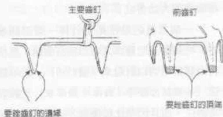
圖13-8 磨利冰爪的方法
