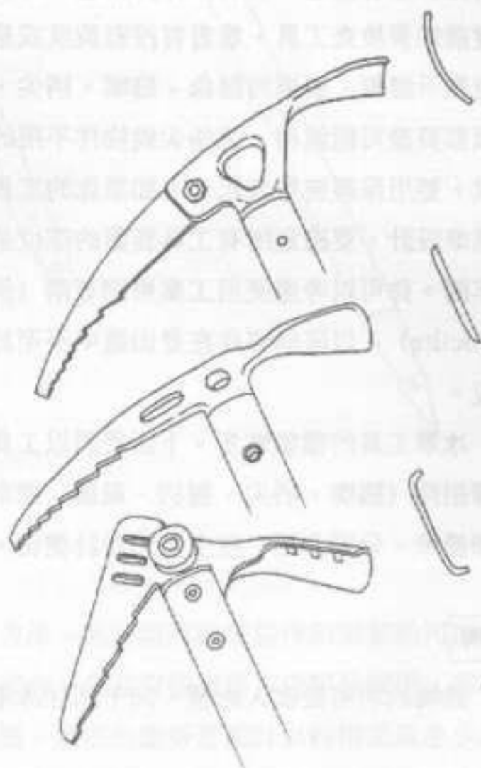
圖15-5 三種扁頭設計的側面和底部圖
