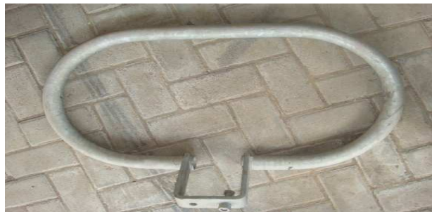
Gambar 31 Arcing horn sisi penghantar
