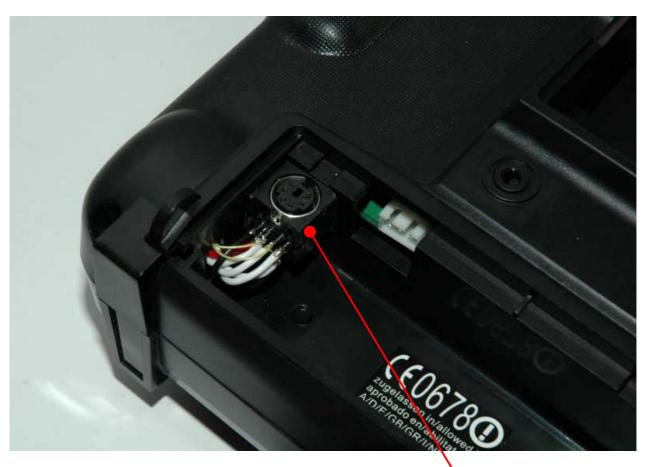
Pas de cordon d'équilibrage (éléments avec circuit de protection)
