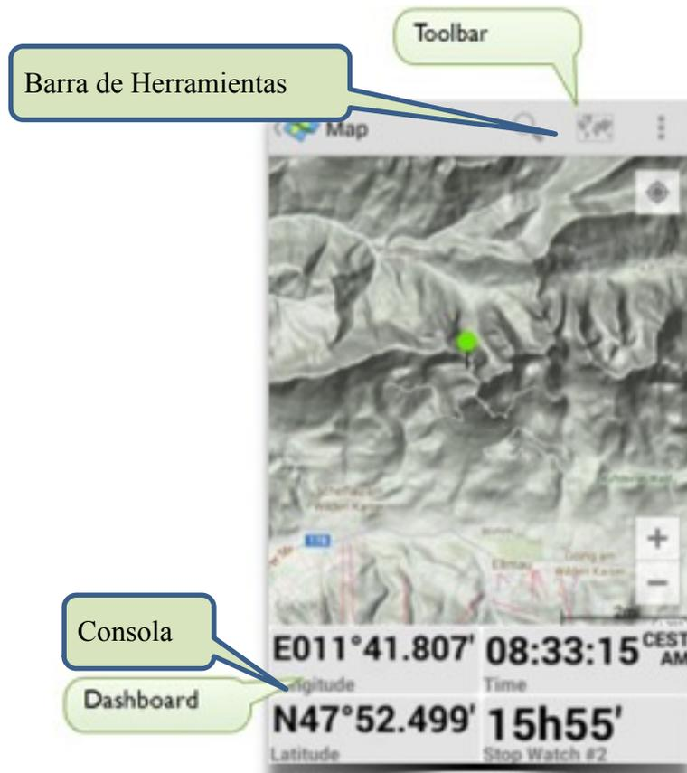
Puede ajustar la cantidad de espacio que desea utilizar para el mapa y la consola arrastrando el control deslizante hacia arriba y hacia abajo (o hacia la izquierda y la derecha en las pantallas horizontales). El deslizador aparece cuando toca en la pantalla cerca de la separación entre el mapa y el tablero de instrumentos. Puede arrastrar el control deslizante hacia abajo hasta que el tablero este completamente oculto y también
