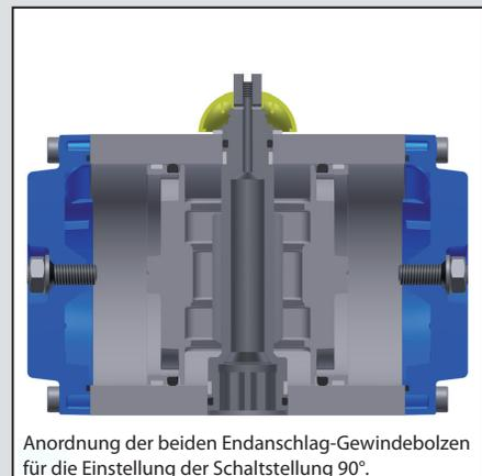
Anordnung der beiden Endanschlag-Gewindebolzen für die Einstellung der Schaltstellung 90°.
