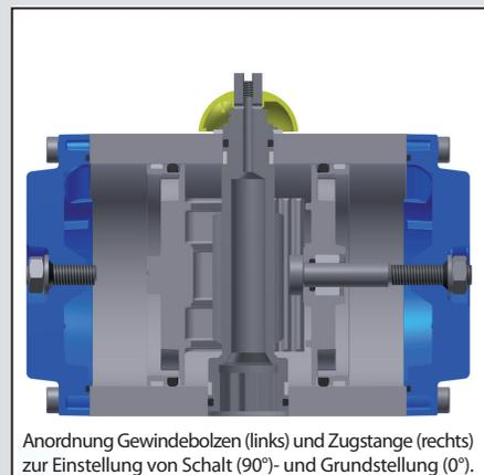
Anordnung Gewindebolzen (links) und Zugstange (rechts) zur Einstellung von Schalt (90°)- und Grundstellung (0°).
