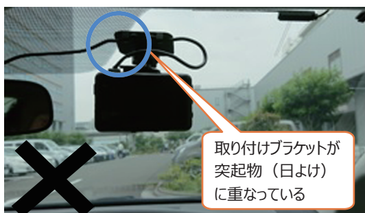
【間違った取付位置】
