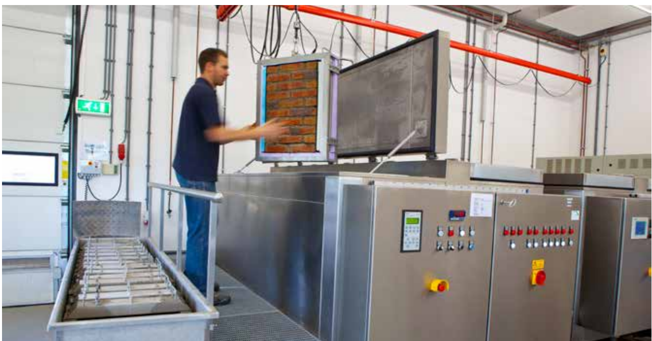
Beproeving element voor bepaling van de vorstbestandheid
