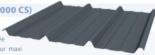
Jl 45-333-1000 Toiture est une plaque nervurée destinée aux couvertures sèches pour des versants de longueur maxi 40 m, de pente courante minimale de 7% à 15% (le DTU 40.35 précise les situations qui correspondent à ces pentes). La laque définie à la commande de Jl 45-333-1000 Toiture est appliquée en face SO.
