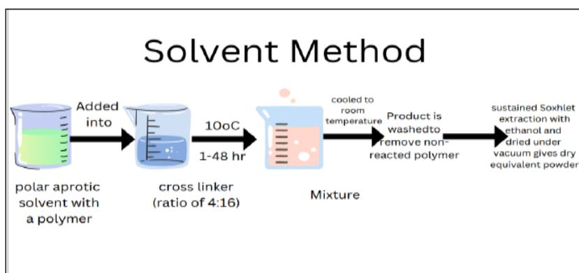
**Fig. 4: solvent Method.**<sup>[6]</sup>
