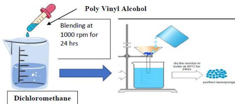
Fig. 6: Emulsion solvent diffusion method.<sup>[6]</sup>
