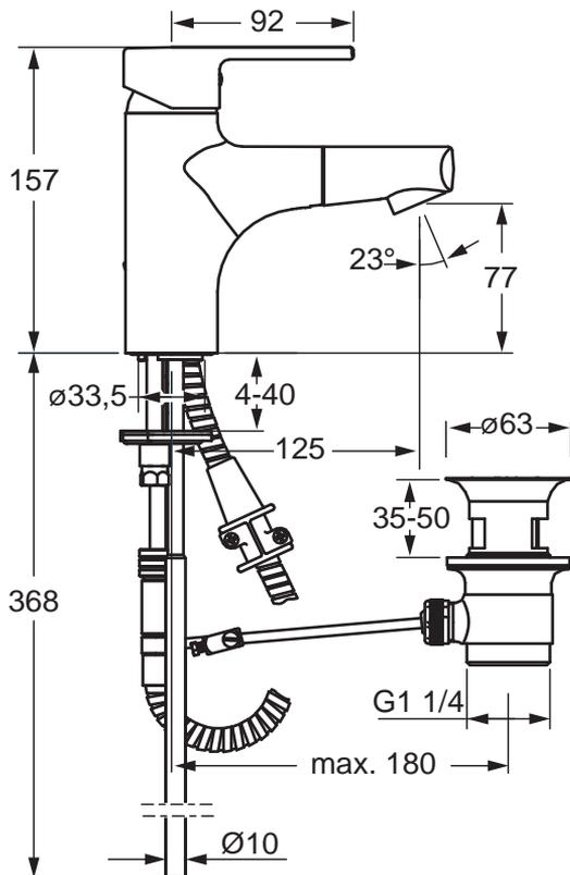
**Hinweis:** Alle HANSA-Armaturen mit Schlauchanschluß sind mit DIN-DVGW geprüfem und zugelassenem Rückflußverhinderer ausgestattet, und gelten somit als eigensicher im häuslichen Gebrauch.
