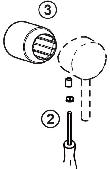
Indstilling af varmtvandsspærring
