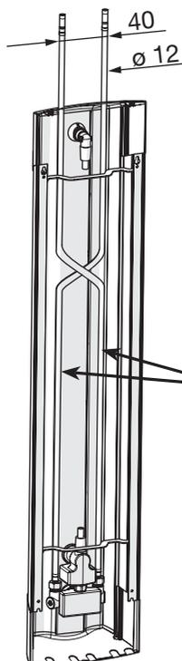
Huom! Joustavat kytkentäputket pitää kytkeä ristiin paneelin takana jotta kylmä ja kuuma vesi kytkeytyvät oikein. Katso merkinät hanarungossa.
