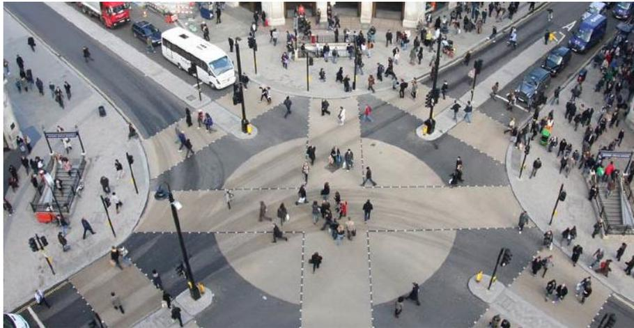
Figure 45 - Traversées sur les lignes de désirs des piétons
