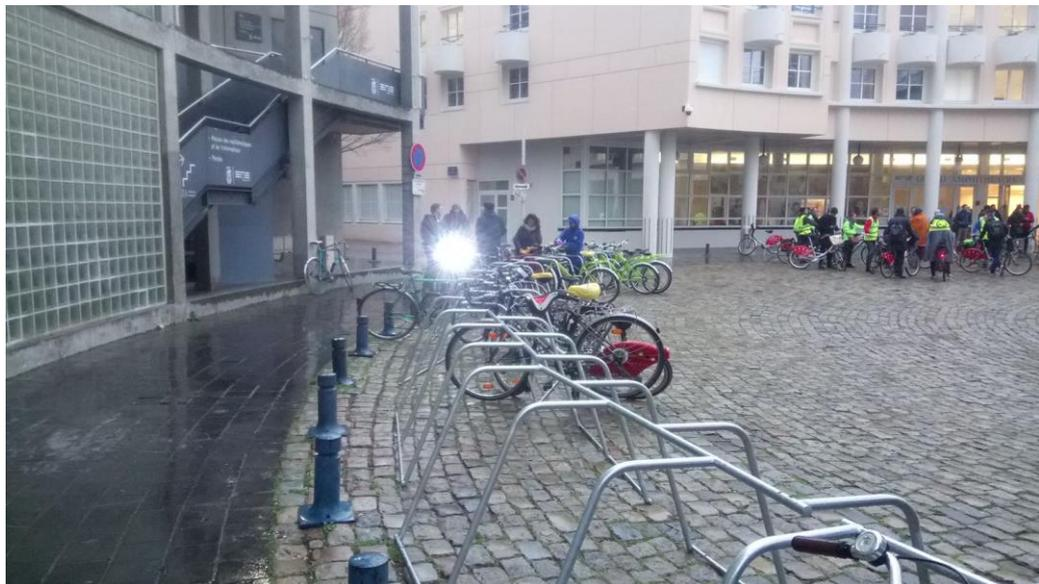
Figure 23 – Exemple de stationnement amovible courte durée
