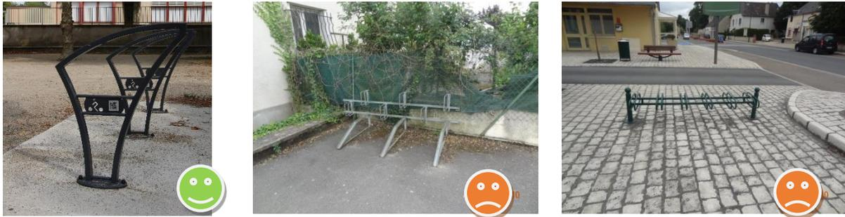
Figure 25 : De gauche à droite : aire de stationnement équipée en arceaux, râtelier et pinces roues à proscrire.
