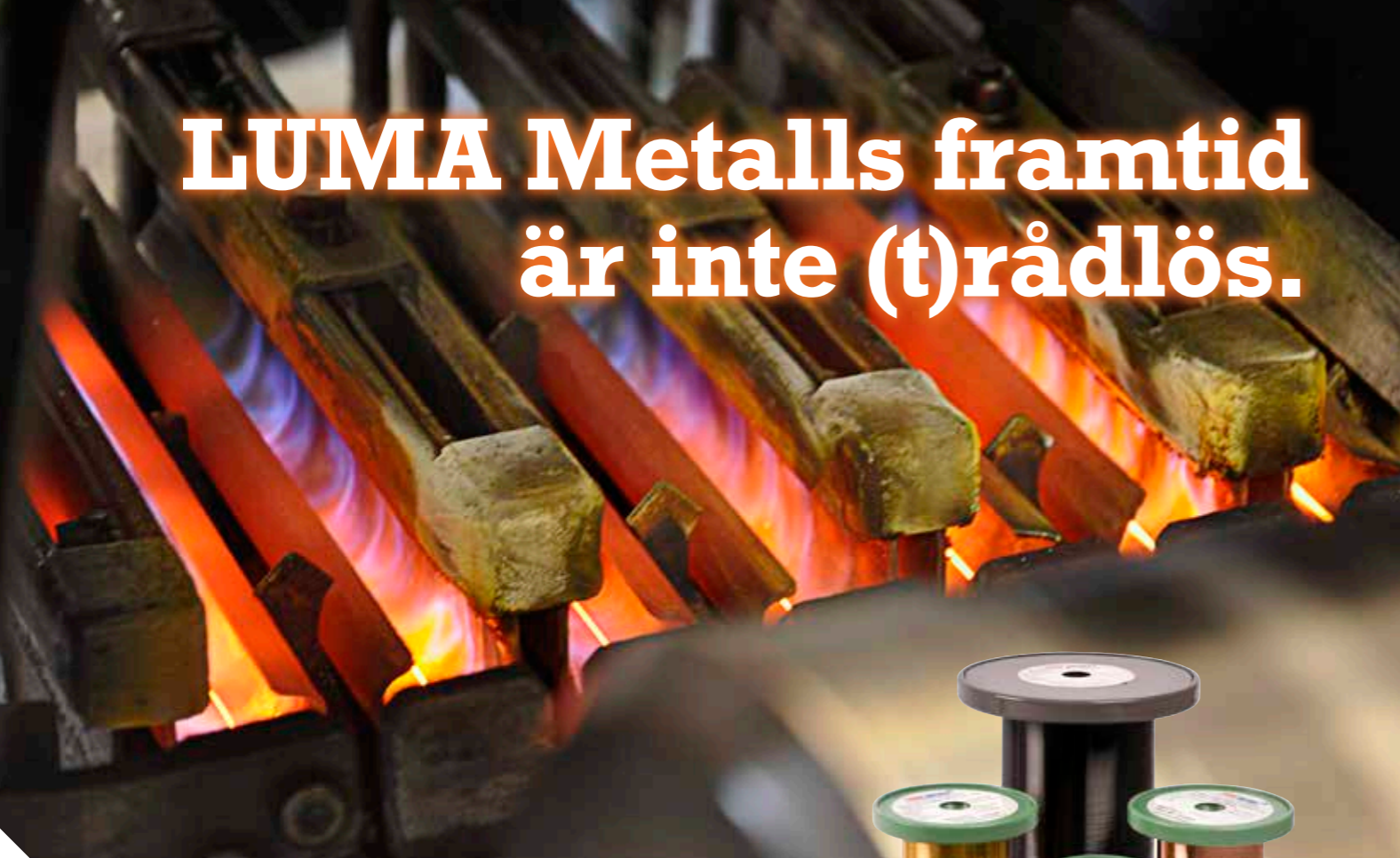
Trådarna dras under värme ner till 4 µ.
