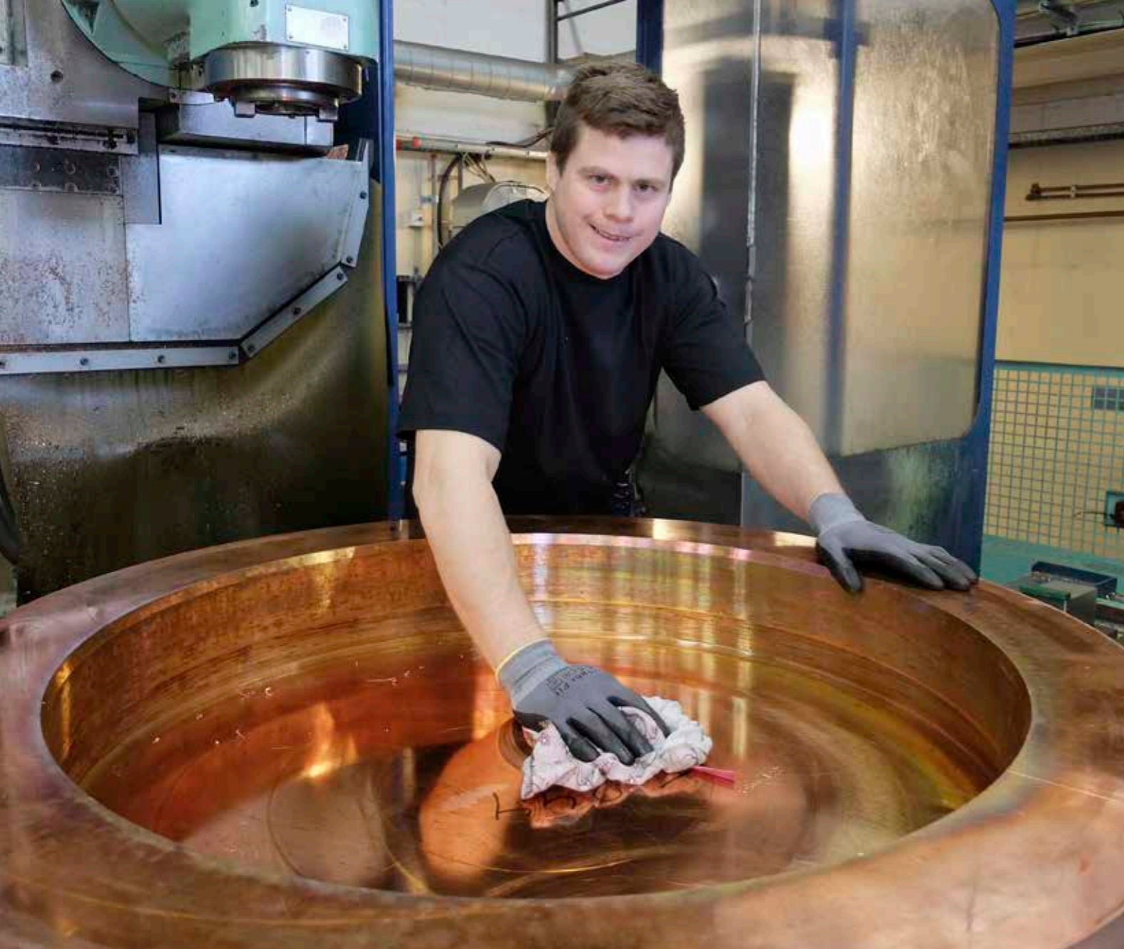
Locken till slutförvaring av kärnbränsleavfall kräver hög precision.
