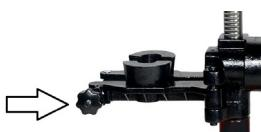
Los brazos de soporte se irán cerrando hasta que el muelle quede sujeto de manera firme. No enrosque más de lo necesario ni ejerza demasiada presión en el amortiguador.
