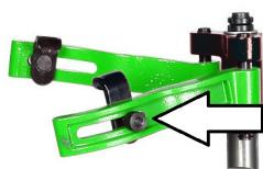
2. Поместить пружину между нижними лапами (6) и вращать нижнюю стопорную гайку по часовой стрелке:
