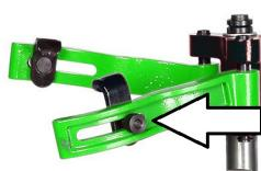
2. Așezați arcul între labele inferioare (6) și roțiți piulița de blocare inferioră în sensul acelor de ceasornic:
