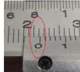
3. Busque la primera línea en la escala vernier que se ajuste perfectamente con una línea de la escala principal.
