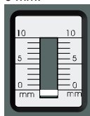
Skale vor dem Arbeitsbeginn Die Marke befindet sich auf der Ebene 0 mm.
