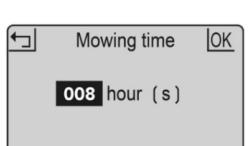
Par exemple, si la durée de fonctionnement est de 8 heures et que le robot tondeuse démarre à 20h00, il terminera son travail à 4h00. Pendant ce temps, la tondeuse peut fonctionner pendant une heure, charger pendant deux heures, tondre pendant une heure, charger pendant deux heures, tonde pendant une heure et se recharger pour une utilisation au cycle suivant.
