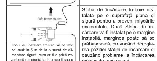
Stația de încărcare trebuie instalată pe o suprafață plană și sigură pentru a preveni mișcările accidentale. Dacă Stația de încărcare va fi instalată pe o margine instabilă, marginea poate să se prăbușească, provocând deregarea poziției stației de încărcare și cauzând probleme la încărcarea mașinii de tuns gazon.
