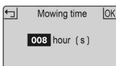
Por ejemplo: si se ajusta a 8 horas y el robot cortacésped está configurado para funcionar a partir de las 20:00 horas, funcionará hasta las 4:00 horas. En este tiempo, puede funcionar durante una hora, cargar durante dos horas, volver a segar durante una hora, cargar durante dos horas, segar durante una hora y volver a cargar para el siguiente ciclo.
