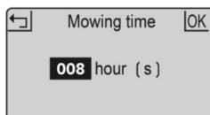
De exemplu, dacă timpul este de 8 ore și mașina de tuns iarba începe la ora 20:00, ea va termina lucrul la ora 4:00. În acest timp, mașina de tuns iarba poate funcționa o oră, apoi să se încarcă timp de două ore, apoi poate tunde încă o oră, și să se încarcă timp de două ore, apoi poate tunde încă o oră și poate să se reîncarcă pentru a fi utilizată în următorul ciclu.
