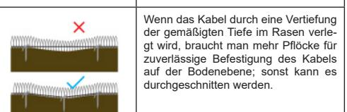
Wenn das Kabel durch eine Vertiefung der gemäßigten Tiefe im Rasen verlegt wird, braucht man mehr Pföcke für zuverlässige Befestigung des Kabels auf der Bodenebene; sonst kann es durchgeschnitten werden.
