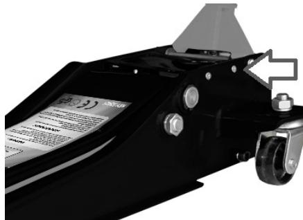
Снимите верхнюю пластину и извлеките маслозаливную заглушку:
