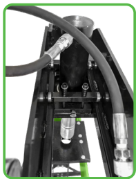
PISTÓN CON DESPLAZAMIENTO HORIZONTAL
