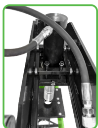
PISTONE CON SPOSTAMENTO ORIZZONTALE
