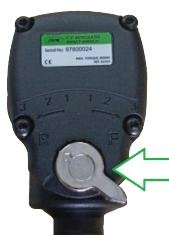
Para rotación en sentido desatornillado, gire el selector de velocidad hacia la izquierda.
