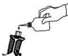
Puneți până la 6 picături de ulei de lubrificare în admisia de aer a pistoloului în fiecare zi de lucru sau la fiecare 2 ore de utilizare continuă dacă unealta nu este conectată la un sistem de lubrificare.
