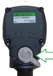
Pentru o rotație deșurubătoare, rotiți selectorul de viteză spre stânga.
