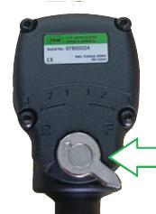
Para uma rotação sem parafusos, rodar o seletor de velocidade para a esquerda.
