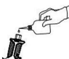
Geben Sie jeden Arbeitstag oder alle 2 Stunden bei Dauerbetrieb bis zu 6 Tropfen Schmieröl in den Lufeinlass der Pistole,
