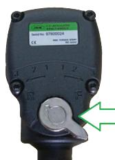
Per la rotazione non avvitata, ruotare il selettori di velocità verso sinistra.
