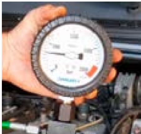
Se il motore non si avvia nonostante la pressione corretta, potrebbe trattarsi di un guasto elettrico/iniettori/meccanico piuttosto che della pompa.
