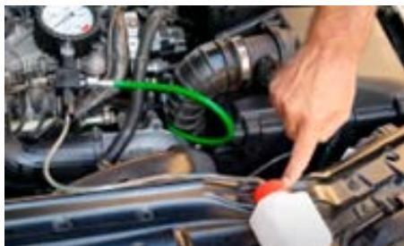
De maximale druk is 1300 bar. Start de motor en controleer of de druk hoger is dan 1050 bar. Als het laag is, is de pomp of de drukregelaar defect. Voer een drukregulairtest van de pomp uit om het probleem op te sporen. Een probleem met de drucksensor op de brandstofleiding kan ertoe leiden dat de drukregelaar te vroeg opent, wat resulteert in lage drukwaarden. Controleer de druk met een EOBD-tool met live gegevens en vergelijk de manometerdruk met de waarde van het tool.
