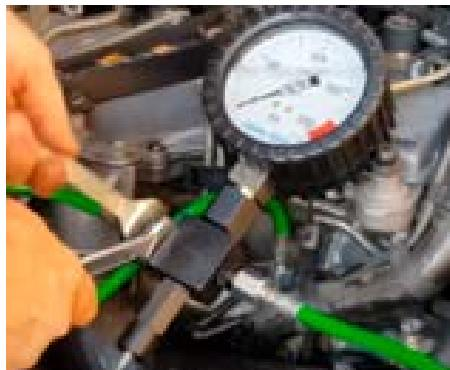
Coloque la tapa metálica en la salida del Co-
