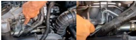
Als het brandstofsysteem drukloos is, koppel dan de toegankelijke hogedrukleiding los en sluit de meter aan met M12- of M14-slangen. Controleer of alle slangkoppelingen goed vastzitten voordat u verdergaat.
