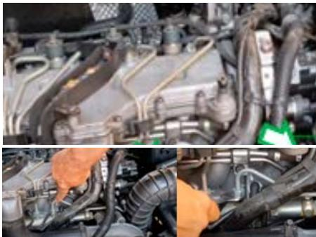
Con el sistema de combustible despresurizado, desconecte la tubería de alta presión accesible y conecte el manómetro con mangueras M12 o M14. Asegúrese de que todos los racores de las mangueras están apretados antes de proceder.
