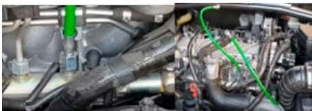
Collegare una bottiglia di diesel di scarso con un tubo alla base del manometro per raccogliere il carburante di scarso quando viene attivata la valvola di sicurezza.
