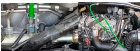
Присоедините бутылку с отработанным дизельным топливом с трубкой в нижней части манометра, чтобы собирать отработанное топливо при срабатывании клапана сброса давления.
