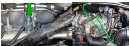
Ligue uma garrafa de resíduos de gasóleo com um tubo ao fundo do manómetro para recolher os resíduos de combustível quando a válvula de descompressão for activada.
