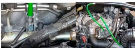
Węzykiem połączyć butelkę na zużyty olej napędowy z dolną częścią manometru, aby zebrać zużyte paliwo po aktywacji zaworu bezpieczeństwa.
