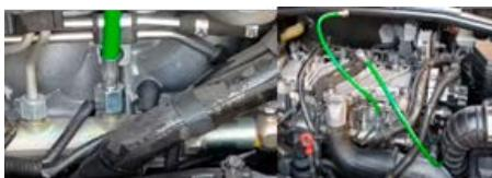
Csatlakoztasson egy csövel ellátott gázolaj hulladékpalackot a mérőműszer aljához, hogy a nyomáscsökkentő szelep aktiválásakor elfolyó hulladék üzemanyagot összegyűthesse.
