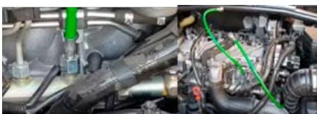
Reliez une bouteille de récupération du diesel avec un tube à la base du manomètre pour collecter les résidus de carburant lorsque le limiteur de pression est actionné.
