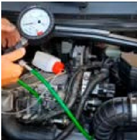
Le moteur peut mettre quelques secondes à répondre en raison de la présence d'air dans le système, et la pression mesurée doit être d'environ 300 bar au démarrage et au ralenti.
