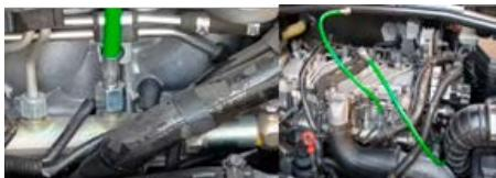
Sluit een diesel afvalfles met een slang aan op de onderkant van de manometer om afvalbrandstof op te vangen wanneer de overdrukklep wordt geactiveerd.
