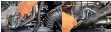
Po zwolnieniu ciśnienia z układu paliwowego, odłączyć dostępny przewód wysokiego ciśnienia i podłączyć manometr za pomocą węzyka M12 lub M14. Przed kontynuowaniem upewnić się, że wszystkie złączki węzyków są solidnie dokręcone.
