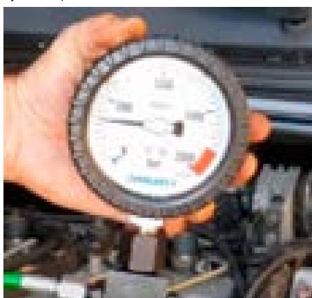
Se o motor não arrancar mesmo com a pressão correcta, talvez haja uma avaria na parte eléctrica/injectores/mecânica e não na bomba.
