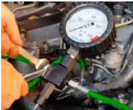
Helyezze a fémkupakot a vizsgálóműszer kiemenetére
