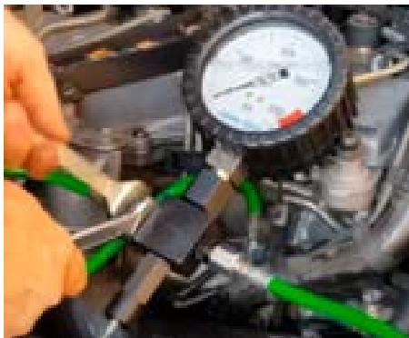
Установите металлический колпачок на выходе тестера
