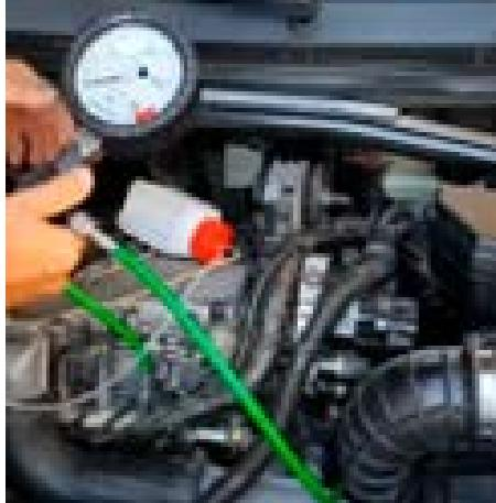
Het kan een paar seconden duren voordat de motor start vanwege lucht in het systeem en de waarde moet rond de 300 bar liggen bij het starten en stationair draaien.
