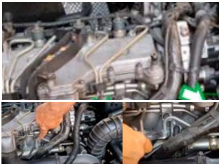
Une fois le circuit de carburant dépressurisé, déconnectez le tuyau haute pression accessible et reliez le manomètre à l'aide de tuyaux M12 ou M14. Assurez-vous que tous les raccords de tuyaux sont bien serrés avant de continuer.
