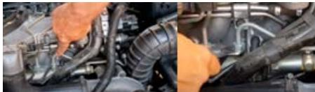
Cu sistemul de combustibil depresurizat, deconectați conducta de înaltă presiune accesibilă și conectați manometrul cu furtunuri M12 sau M14. Asigurați-vă că toate fittingurile fur tunului sunt strânse înainte de a continua.
