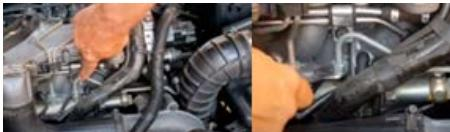
Con l'impianto di alimentazione depressurizzato, scollegare il tubo dell'alta pressione accessibile e collegare il manometro con tubi flessibili M12 o M14. Prima di procedere, accertarsi che tutti i raccordi del tubo siano ben stretti.
