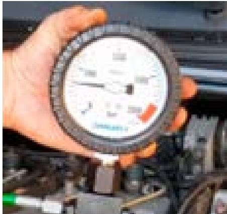
Si el motor no arranca a pesar de la presión correcta, podría ser un fallo eléctrico / inyectores / mecánico en lugar de la bomba.
