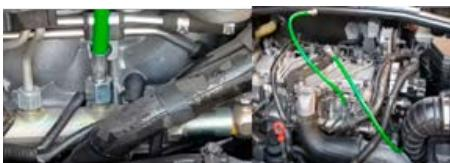
Schließen Sie eine Dieselabfallflasche mit einem Schlauch an den Boden des Messgeräts an, um den Abfall aufzufangen, wenn das Überdruckventil aktiviert wird.
