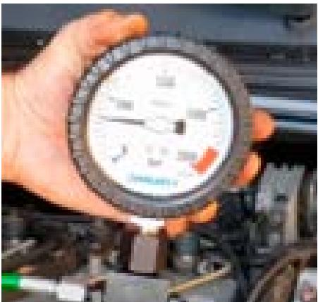
Si le moteur ne démarre pas malgré une pression correcte, cela peut être dû à un défaut électrique/d'injecteurs/mécanique plutôt qu'à un problème au niveau de la pompe.
