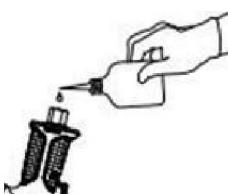
Puneți până la 6 picături de ulei de lubrificare în admisia de aer a pistoloului în fiecare zi de lucru sau la fiecare 2 ore de utilizare continuă dacă unealta nu este conectată la un sistem de lubrificare.
