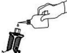
Geben Sie jeden Arbeitstag oder alle 2 Stunden bei Dauerbetrieb bis zu 6 Tropfen Schmieröl in den Lufeinlass der Pistole,
