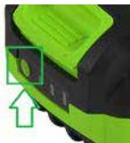
Nyomja meg az irányválasztót a négyzetű vezérlő irányának kiválasztásához.
