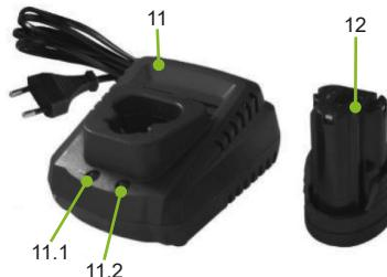
Insérez la fiche du chargeur dans le secteur. Après cela, l'indicateur LED signalant que l'appareil est en mode veille, clignotera. Insérez l'unité de batterie dans le compartiment du chargeur. En conséquence, l'indicateur LED rouge s'allumera en continu. Cela indique une charge rapide automatique de l'unité de batterie. Dès que cette unité est chargée, l'indicateur LED vert s'allumera. Retirez l'unité de batterie du chargeur et débranchez le chargeur.
