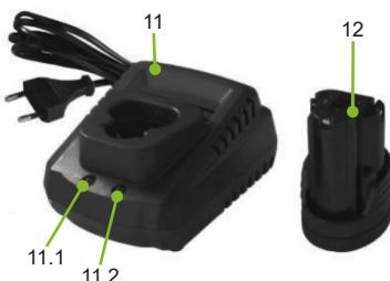
Helyezze a töltő csatlakozóját a hálózatba. Ezután a LED jelzőfény villog, jelezve, hogy az eszköz készénláti állapotban van. Helyezze az akkumulátort a töltőrekeszbe. Ennek eredményeként a piros LED folyamatosan világítani kezd. Ez az akkumulátor gyors töltését jelzi. Amint az utolsó töltődik, a piros LED kialszik, és a zöld LED kigyullad. Vegye ki az akkumulátort a töltőből és húzza ki a töltőt.
