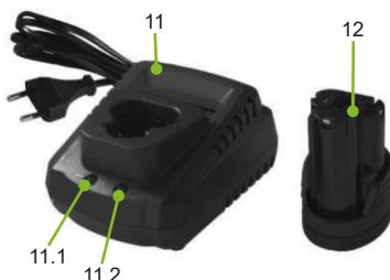
Steek de stekker van de oplader in het netwerk. Daarna knippert de LED-indicator, om aan te geven dat het apparaat in de standby-modus staat. Plaats het batterijpakket in het opladocompartiment. Hierdoor gaat de rode LED continu branden. Dit duidt op automatisch snel opladen van het batterijpakket. Zodra het laatste is opgeladen, gaat de rode led uit en gaat de groene led branden. Haal het batterijpakket uit de oplader en trek de oplader uit het netwerk.
