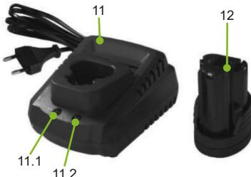
Insira a ficha do carregador na rede. Depois disso, o indicador LED pisca, sinalizando que o dispositivo está no modo de espera. Insira a bateria no compartimento do carregador. Como resultado, o LED vermelho acenderá constantemente. Isso indica o carregamento rápido automático da bateria. Assim que o último for carregado, o LED vermelho se apagará e o LED verde acenderá. Retire a bateria do carregador e desconecte o carregador.
