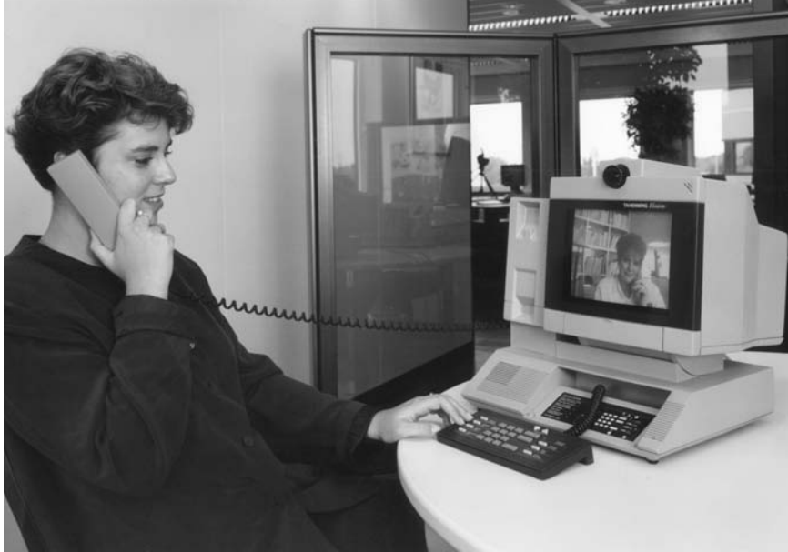
Afbeelding van de Tandberg Vision in Welkom in 2000 met het onderschrift: 'ISDN-beeldtelefoon tussen het 'Kantoor van de Toekomst' en het 'Huis van de Toekomst' in Rosmalen'. Bron: C. Titulaer, Welkom in 2000, Houten 1993, p. 59. Het toestel dat veel op een computer lijkt – maar bijvoorbeeld geen QWERTY-toetsenbord heeft – heeft een ingebouwde camera, telefoonhoorn en bedieningspaneel. Foto: Chriet Titulaer Producties b.v. Scan origineel en retouche: T. Sixma
