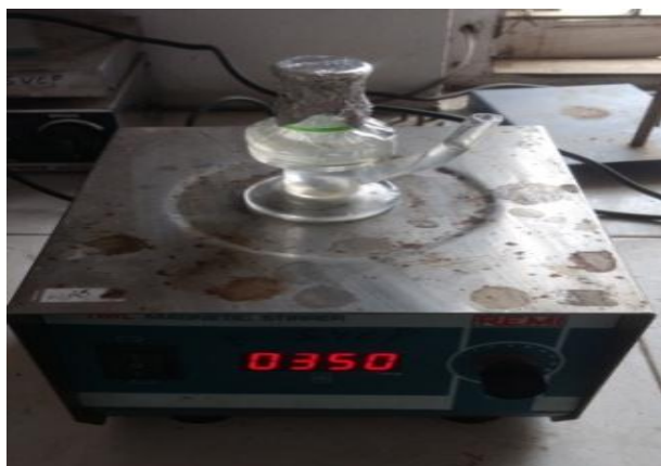
Fig. 4: Franz diffusion cell & magnetic stirrer.
