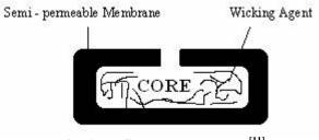
Fig. 6: En So Trol Technology.<sup>[11]</sup>
