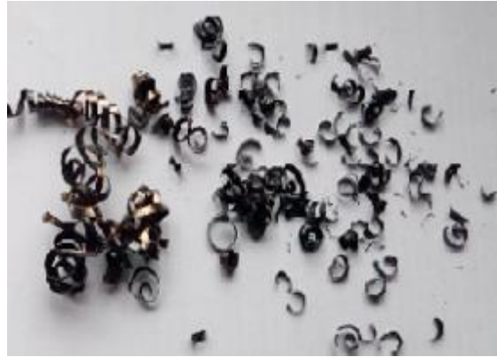
(d) At v_c = 410 m/min, s_0 = 0.14 m/min, & t = 2.05 mm
