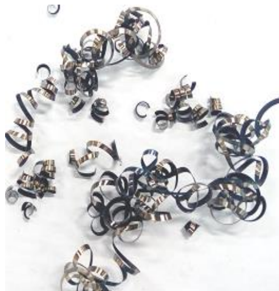
(d) At v_c = 410 m/min, s_0 = 0.14 m/min, & t = 2.05 mm
