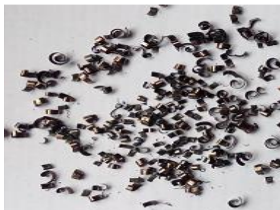
(d) At v_c = 410 \text{ m/min} , s_o = 0.14 \text{ m/min} , & t = 2.05 \text{ mm}
