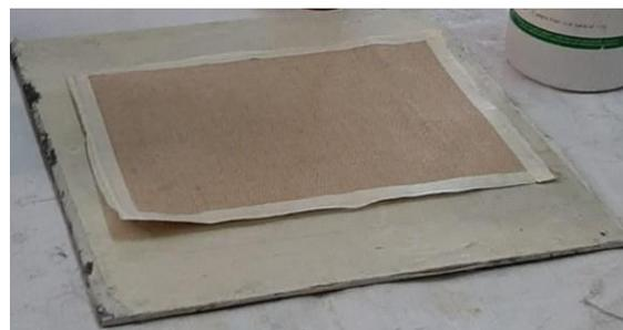
(d). Applying first layer of flax fibre.
