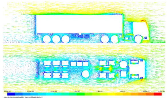
Hình 4. Vận tốc dòng bao quanh thân xe trong trạng thái đoàn xe chở container 40 feet
