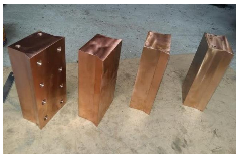
Hình 1. Bộ điện cực hàn xích neo tàu hải quân
