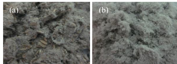
Hình 5. Hình dạng sau nghiền của các mẫu (a) da cật (b) da váng bằng phương pháp nghiền búa
