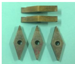
Hình 3. Mảnh dao hợp kim cứng dùng cho thí nghiệm
