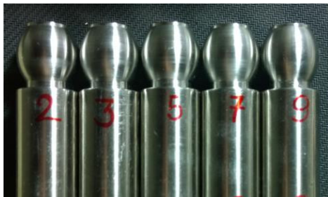
Hình 5. Mẫu thép SUS304 sau khi gia công
