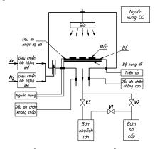
**Hình 2.** Sơ đồ nguyên lý của thiết bị chân không VTD 30 với bộ DC magnetron và gá mẫu.
