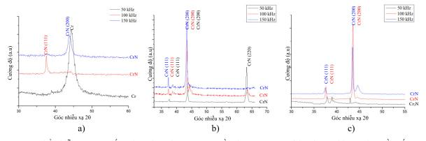
**Hình 5.** Phổ nhiễu xạ XRD lắng đọng lớp phủ CrN trên nền thép SKD61 với lưu lượng khí N<sub>2</sub> đo ở tần số xung (f) khác nhau: (a) N<sub>2</sub> = 4 sccm, (b) N<sub>2</sub> = 6 sccm, và (c) N<sub>2</sub> = 8 sccm.
