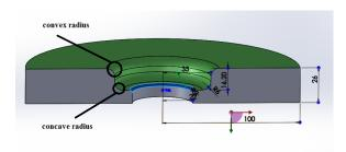
Fig. 5. Hydrostatic die
