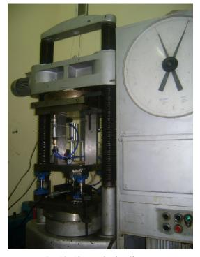
Fig. 12. 125-ton hydraulic press
