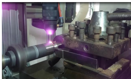
Hình 1. Sơ đồ tiện vật liệu cứng có gia nhiệt bằng laser.
