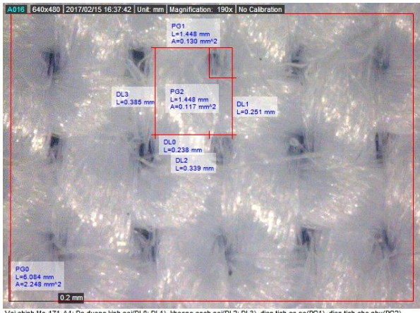
Vải chính M0-171-A1: Đo đường kính sợi(DL0; DL1), khoảng cách sợi(DL2; DL3), diện tích cơ sợi(PG1), diện tích che phủ(PG2).
