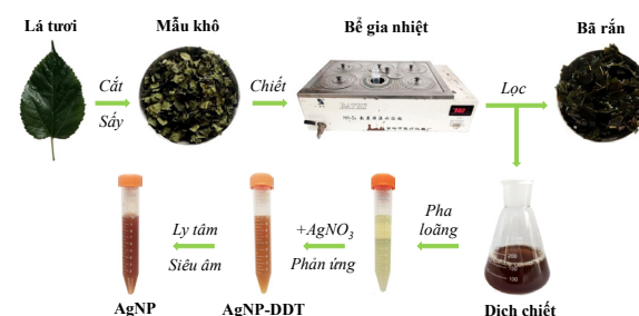
Hình 1. Sơ đồ quy trình chiết tách hợp chất trong lá dâu tằm và tổng hợp nano bạc.
