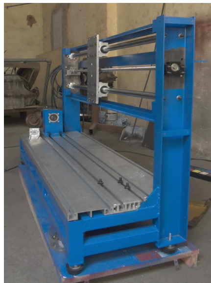
Hình 14. Khung máy được chế tạo (một số thanh thép được bổ sung để gá lắp vỏ máy)
