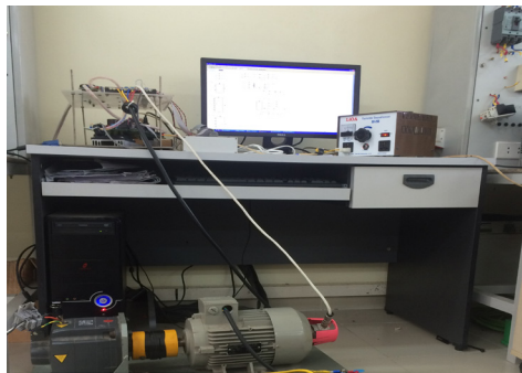
Hình 5. Bàn thực nghiệm sử dụng dS 1104.
